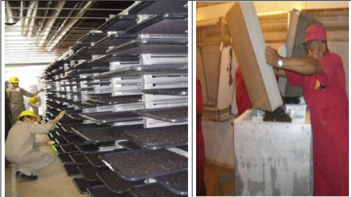
Las charolas de pupas se acondicionan para preparar las cargas que se introducen en el aparato de irradiación.
